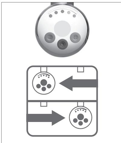
**ЭлектроTЭН устанавливается слева или справа на корпусе полотенцесушителя**
